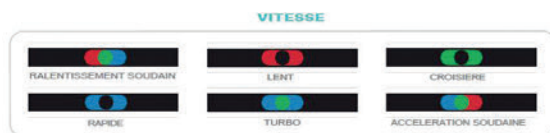
3 Exemples d'ozocodes agissant sur la vitesse du robot
