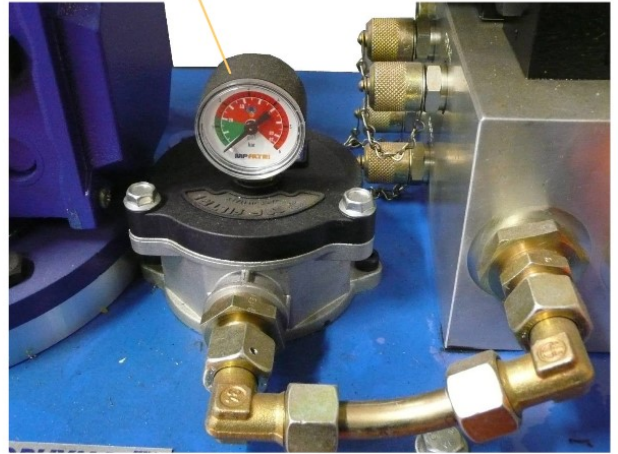
Filtre retour avec indicateur de colmatage.
