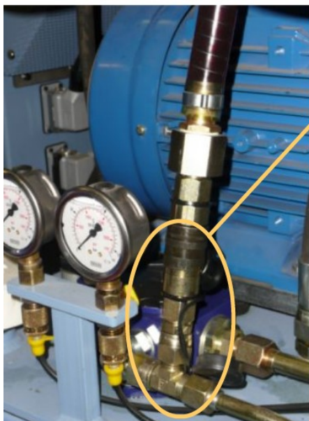
Raccordement du groupe de filtration sur push-pull
