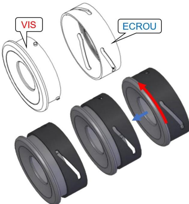
Système Twist-up du déploiement de la bonnette d'un oculaire de jumelle.
