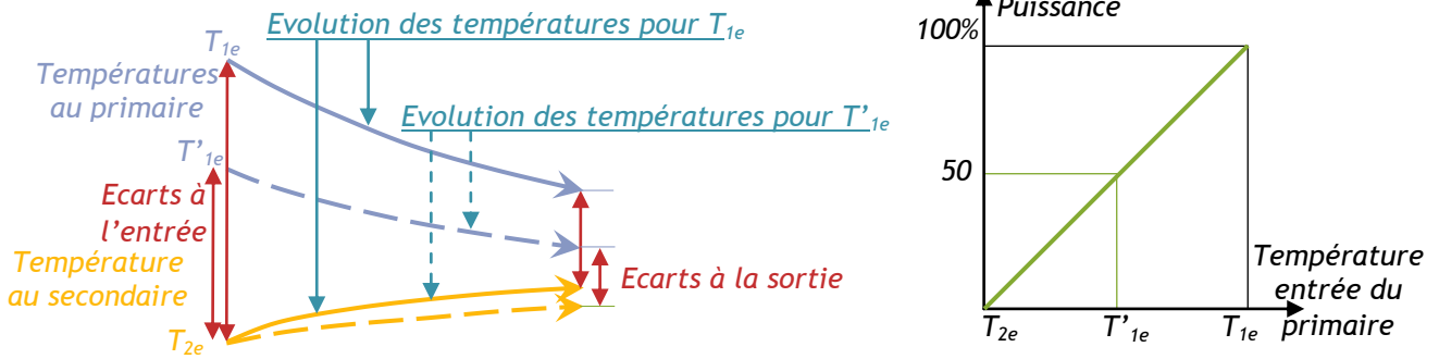
Figure 25 : Impact de la variation de température sur la variation de la puissance échangée pour un échangeur co-courant
