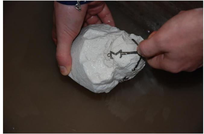
Figure 27 : Phase de trempage du cylindre de coulée et désagrégation du matériau réfractaire
