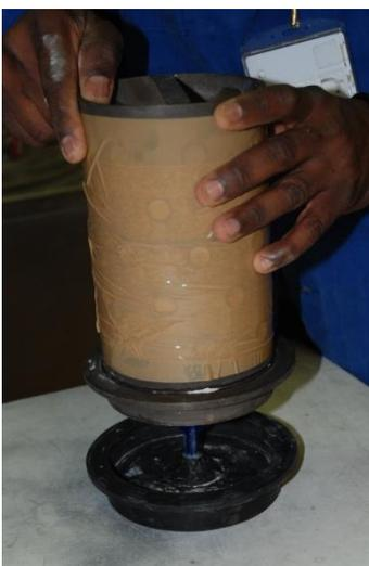
Figure 11 : Positionnement du cylindre sur le support de grappe
