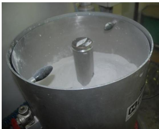
Figure 17 : Panier à matière sèche positionné dans le cylindre éclipable
