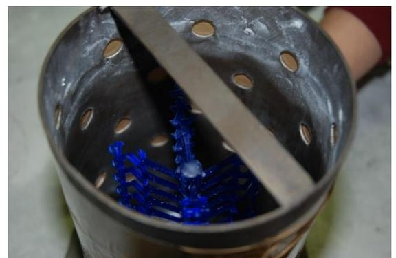
Figure 13 : Cylindre prêt à la coulée de barbotine
