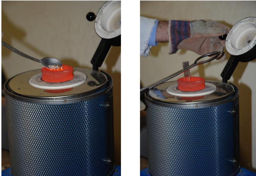
Figure 25 : Insertion de l'argent dans le creuset à température (ce qui lui donne la couleur rougeoyante)
