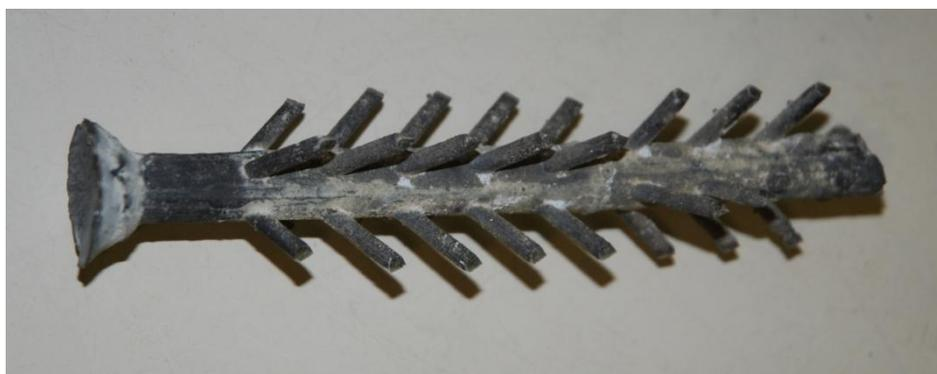
Figure 29 : Canaux de coulée et d'alimentation qui seront recyclés
