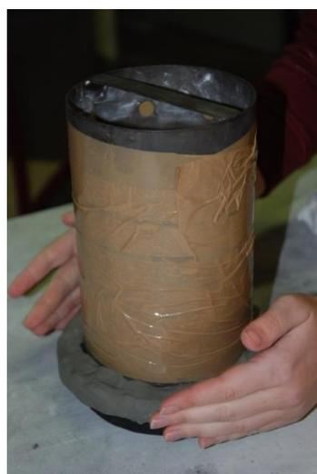
Figure 12 : Etanchéité support/cylindre
