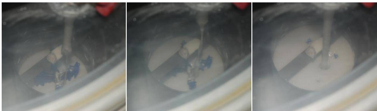
Figure 19 : Coulée de la barbotine dans le cylindre contenant le modèle
