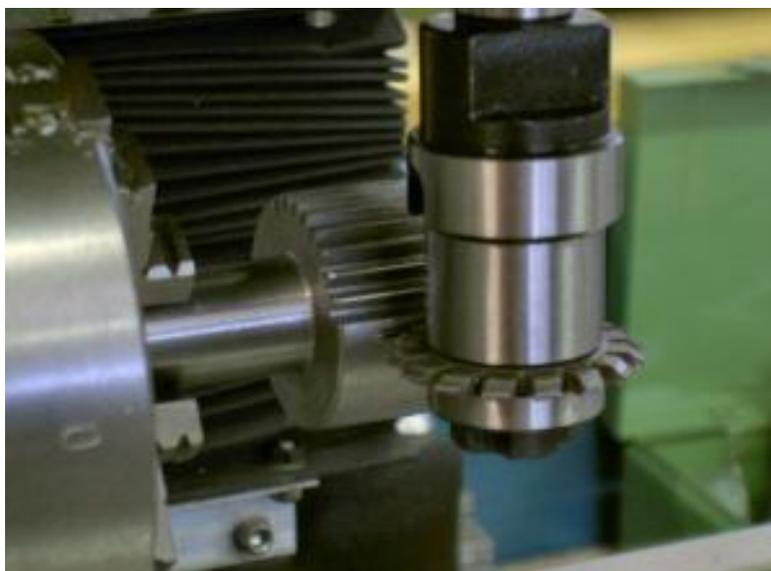
Figure 1 : Exemple de taillage d'une roue par fraise-module, Image Sideméca [1]
