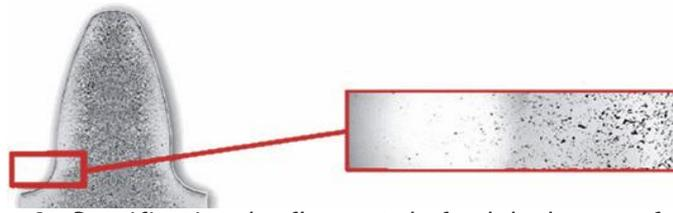
Figure 9 : Densification des flancs et du fond de dent par frittage
