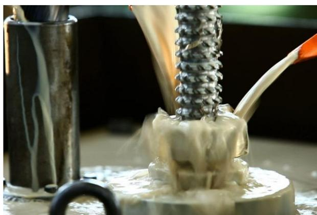
Figure 6 : Usinage par brochage, image BART [3]
