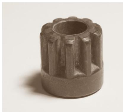
Figure 7 : Roues coniques et pignon droit obtenus par forgeage
