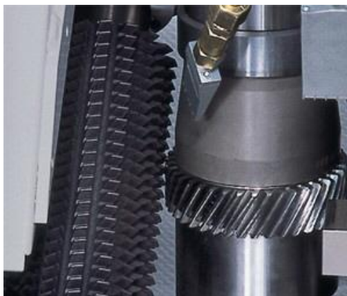
Figure 7 : Exemple de longue fraise-mère, image Liebherr [3]
