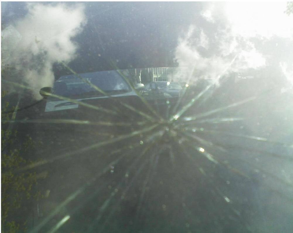
Figure 1 : Propagation de fissures sur un pare-brise
