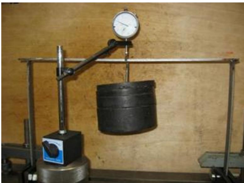
Figure 8 : Dispositif d'application de la charge au portique pour le cas de chargement 2
