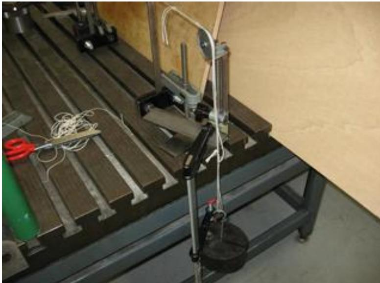
Figure 7 : Dispositif d'application de la charge au portique pour le cas de chargement 1
