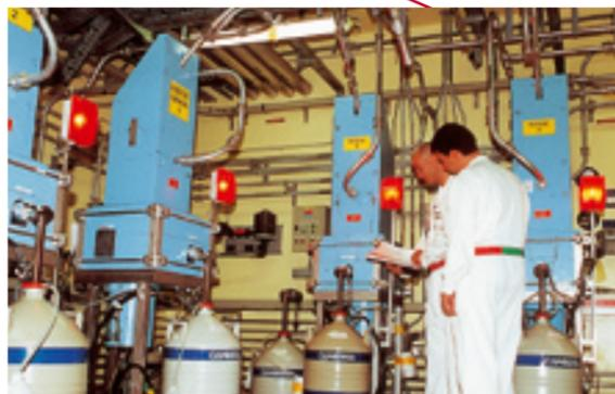
Laboratoire UP3 : analyse automatique par rayons X sur un Kedge (concentration U et Pu).
