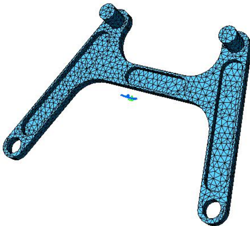
Figure 5 : Maillage du support de conduite.
