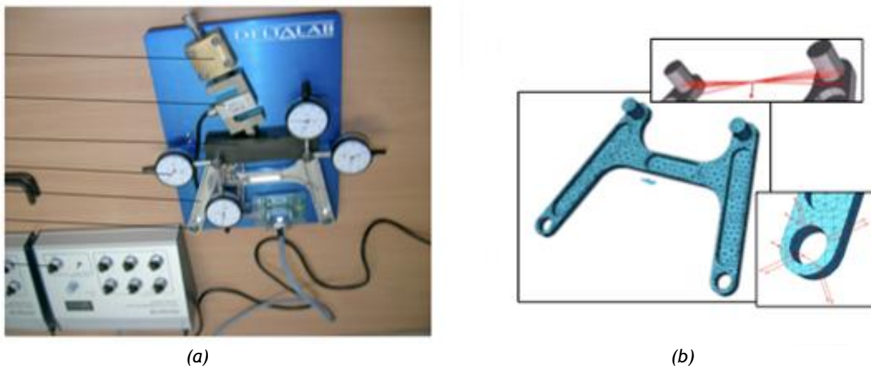
(a) Une maquette didactisée ; (b) une modélisation par éléments finis de cette maquette et des phénomènes qui s'y déroulent.
