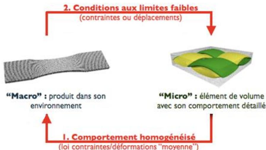
Figure 5 : Principe général du couplage des modèles « macro » et « micro ».
