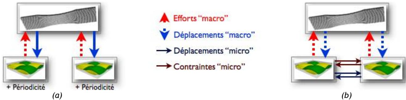
Figure 9 : Deux approches pour la détermination précise des conditions aux limites « macro » : (a) utilisation d'hypothèses de périodicité, (b) couplage des cellules « macro » entre elles.
