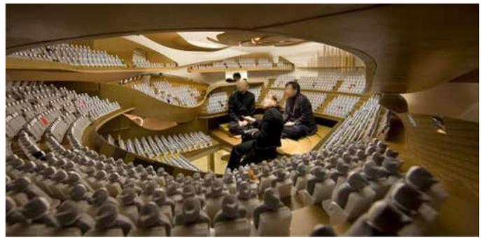
Figure 20 : Maquette au 1/10<sup>e</sup> de la salle de la Philharmonie de Paris testée par des acousticiens, Images [9] et N. Borel
