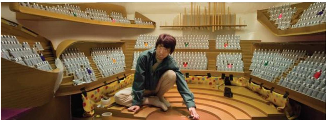
Figure 21 : Maquette au 1/10<sup>e</sup> de la salle de la Philharmonie de Paris lors d'un essai [8]
