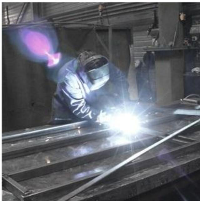
Figure 1 : Réalisation d'un châssis mécano-soudé, image [1]
