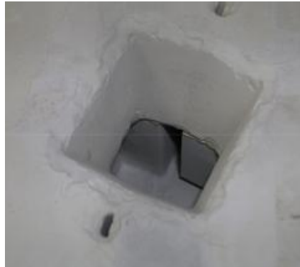
Figure 5 : Vue de l'empreinte dans le moule bloc à travers l'attaque de la coulée
