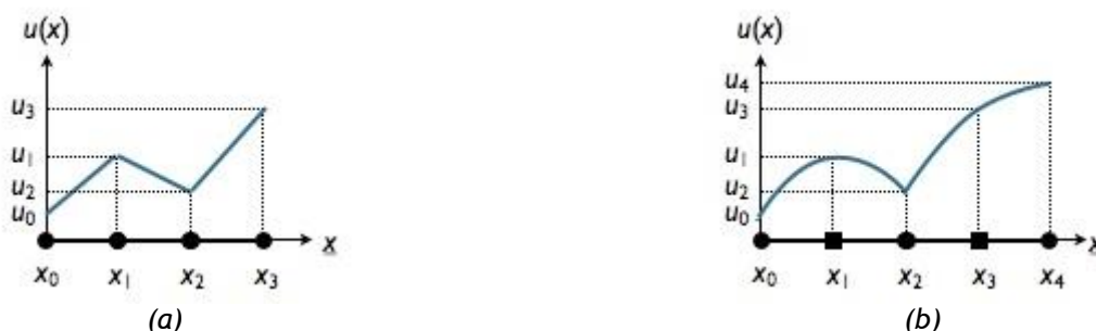
Figure 4 : Deux interpolations simples d'un champ de déplacement 1D (issu de la théorie des poutres, par exemple) : (a) avec des fonctions affines par morceaux, (b) avec des fonctions quadratiques par morceaux.
