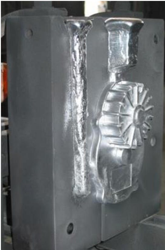
Figure 6 : Pièces en aluminium, moule coquille ouvert, images Fonderies de Nangis [4]
