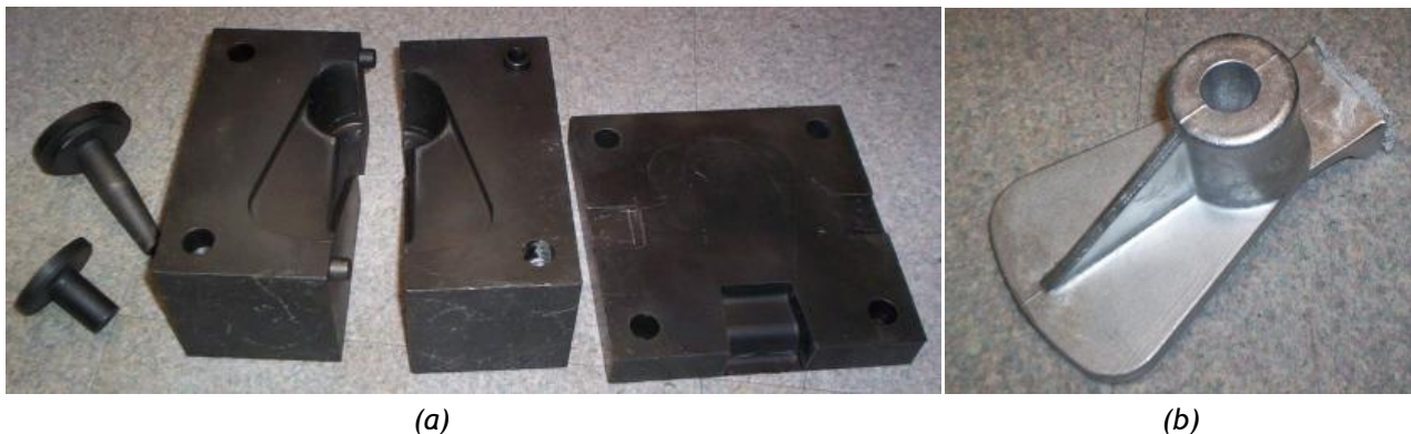
Figure 1 : (a) Coquille éclatée avec ses broches, (b) pièce obtenue en alliage d'aluminium (Al Si9 Cu3 Mg)
