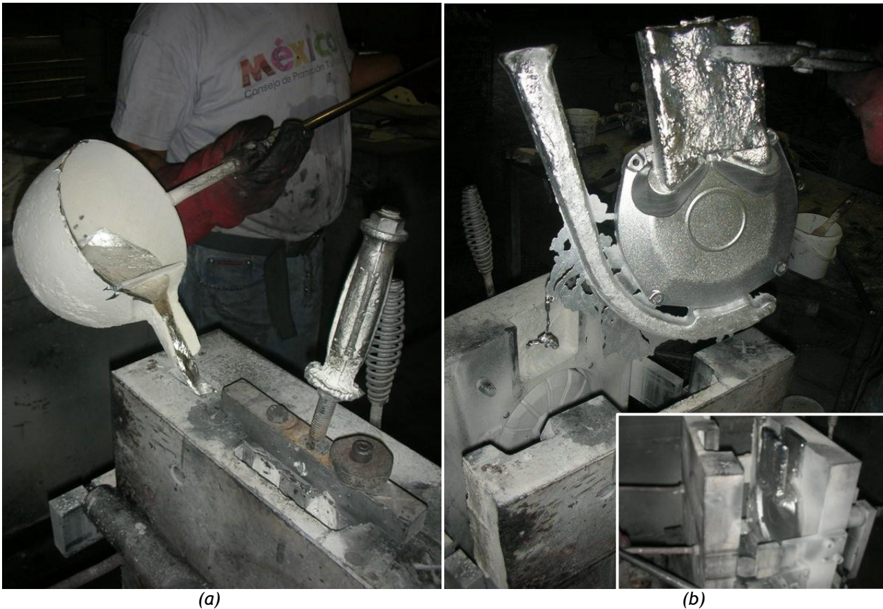
Figure 6 : (a) coulée de l'alliage d'aluminium en fusion, (b) sortie de la pièce (photo en insert : la pièce dans la coquille ouverte), images Fonderie Aluminium Sesam [2]
