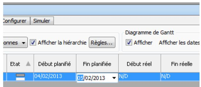
**Remarque:** on aperçoit à droite des colonnes **Début réel** et **Fin réelle** qui permettent de suivre l'évolution réelle du chantier par rapport à la prévision.
