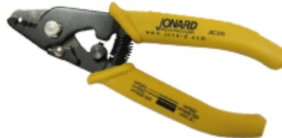
Enlever sur l'extrémité du pigtail où il n'y a pas de connecteur, toutes les gaines de revêtement sur une longueur de 30 à 40 mm afin de ne laisser que la partie en verre. Pour cela, utiliser le trou 125  $\mu\text{m}$  de la pince à dénuder.
