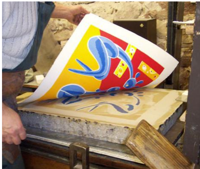
Figure 14 : Lithographie polychrome : une impression par couleur donc une pierre par couleur Ici avec la pierre pour la couleur bleue Image ARTEnovance [7]
