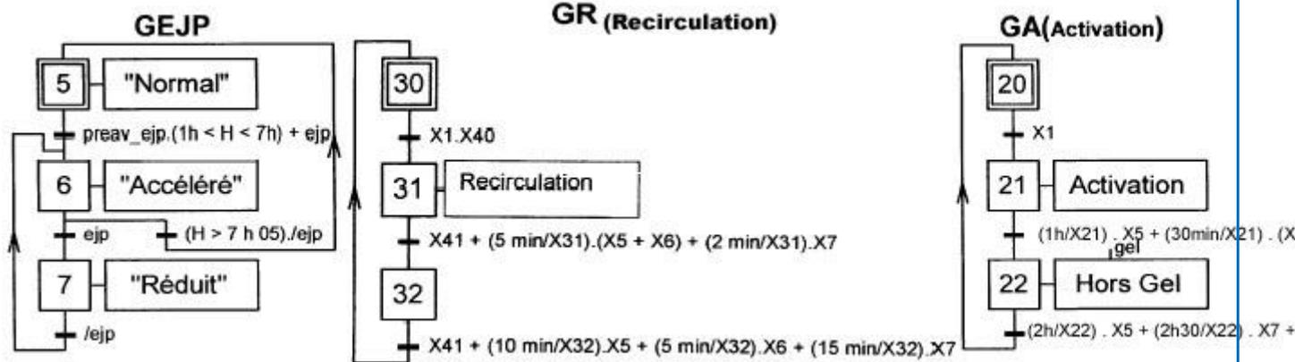
Le principe de mise hors gel est le suivant : dès que le risque de gel apparaît (descente de la température de l'eau au voisinage de l'activateur en-deçà d'un certain seuil) l'activateur est maintenu en rotation à vitesse réduite hors phase d'activation.
