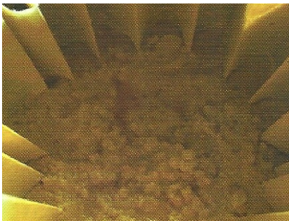
Filtrage de la concrète
