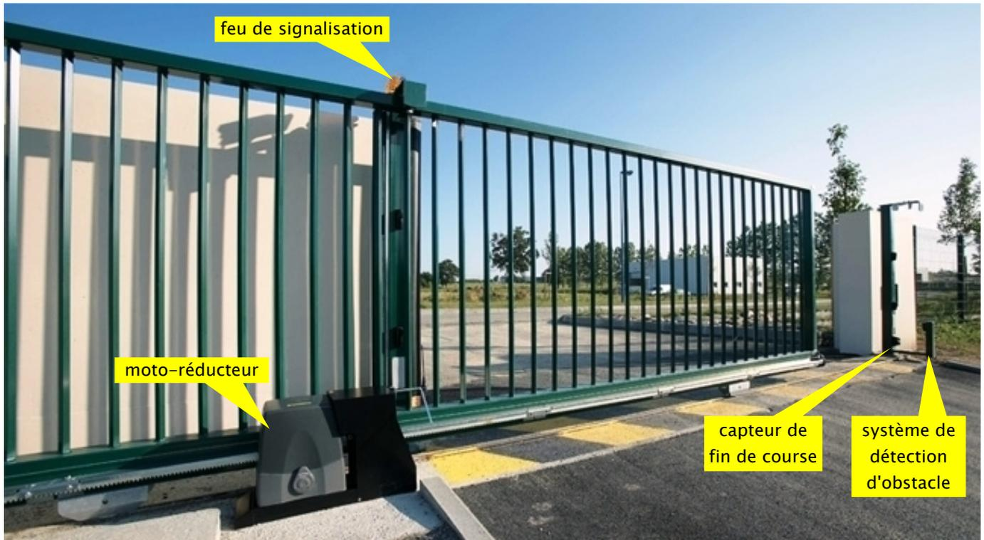
La barrière se déplace grâce à un moteur asynchrone triphasé associé à un réducteur de vitesse et une transmission pignon-crémaillère. Deux capteurs de fin de course donnent le signal pour arrêter le moteur une fois la barrière ouverte ou fermée. Le système a **deux modes de fonctionnement** :
