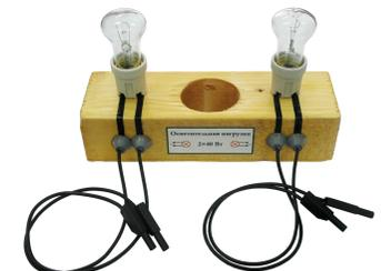
simulateur de récepteurs résistifs (lampes 40 W)
