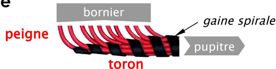
❖ Liaisons vers les récepteurs et les capteurs ► **câbles multipolaires**
