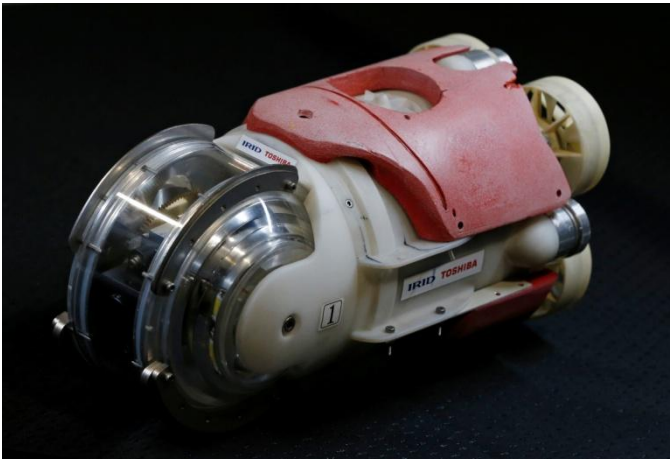
Figure 7 : « Little sunfish » explore la cuve de confinement primaire de la tranche 3 de la centrale nucléaire de Fukushima, afin d'évaluer ses dommages et de localiser des parties de combustible fondu qui seraient submergées sous de l'eau très contaminée, source AP Photo/Shuji Kajiyama [6]
