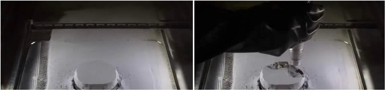
Figure 17 : Remontée du plateau et aspiration des poudres non fusionnées, extraits de la vidéo « Impression 3D : aspiration des poudres non fusionnées dans l'enceinte d'impression de la FormUp 350 » [13], source N. Muller
