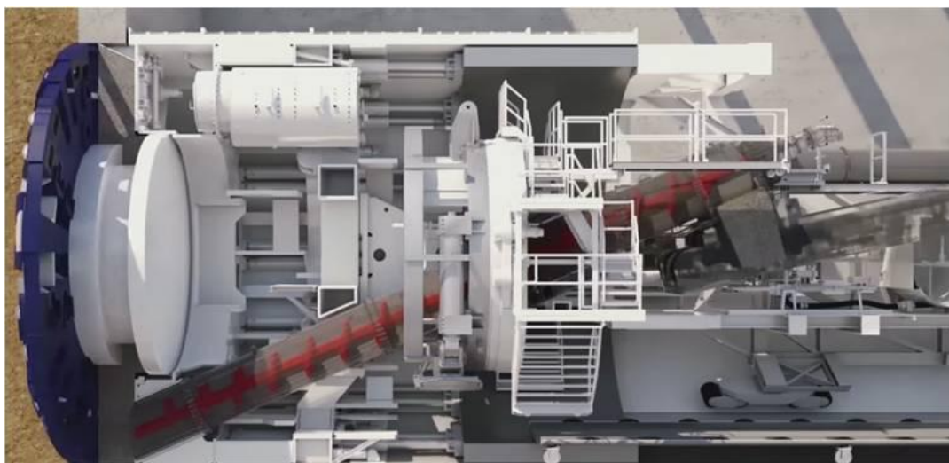
Figure 16 : Évacuation des déblais par la vis d'Archimède vers le convoyeur, source [4]
