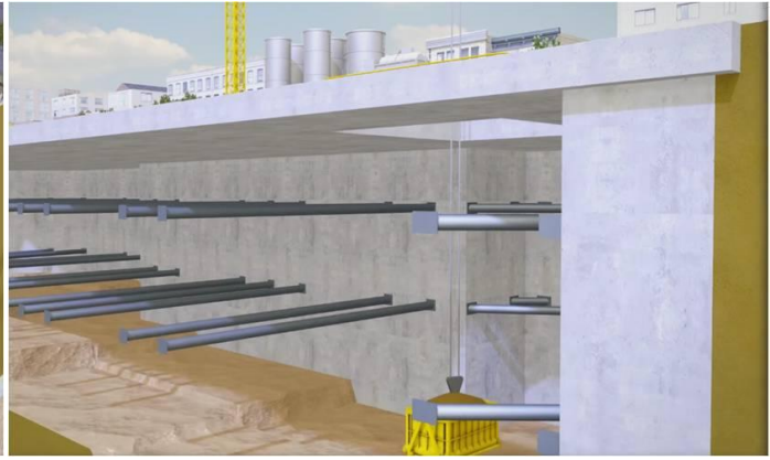
Figure 5 : Creusement en taupe et installation de butons, source [2]
