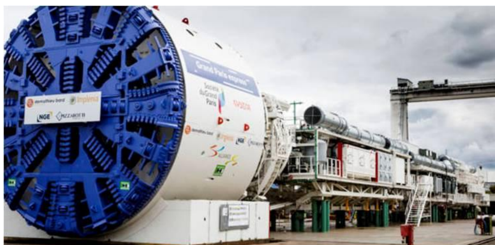
Figure 18 : Tunnelier de Champigny avec une partie du train suiveur à droite, source Laurent Villeret [5]
