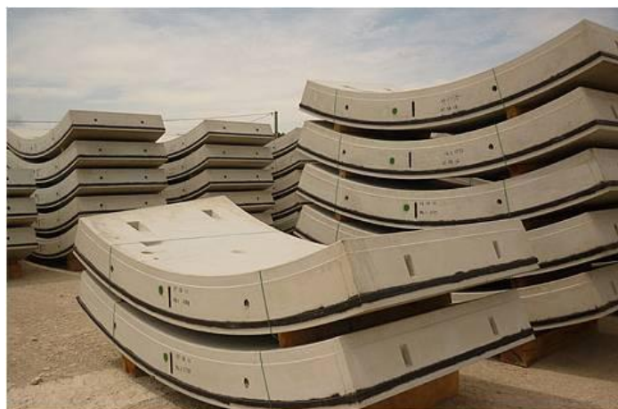
Figure 13 : Exemple de voussoirs en béton préfabriqués, source [6]
