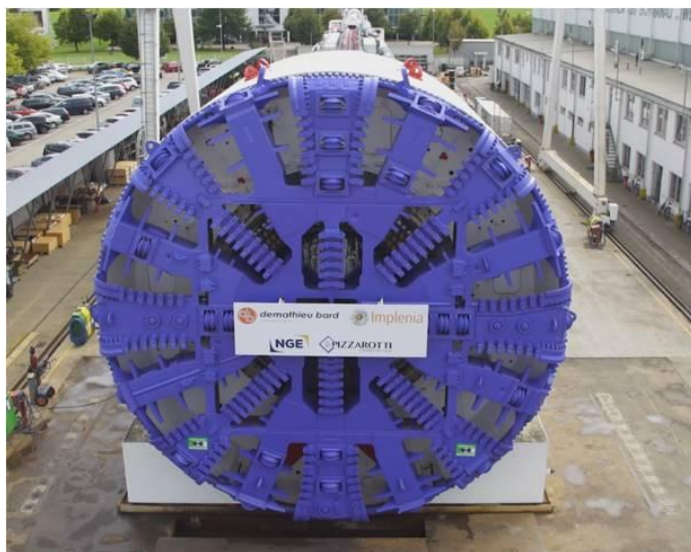
Figure 11 : Tête de coupe du premier tunnelier du Grand Paris Express, installé à Champigny-sur-Marne, dans le Val-de-Marne, diamètre 10 mètres, source [5]
