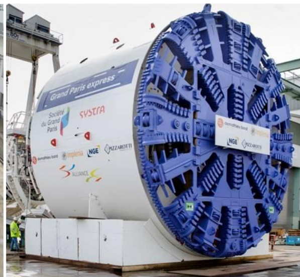
Figure 12 : Tête de coupe et bouclier du tunnelier de Champigny-sur-Marne, source Laurent Villeret [5]
