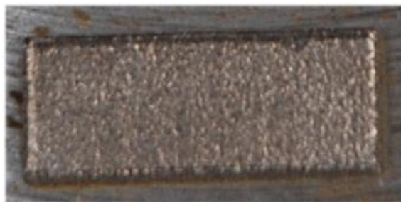
Figure 7 : Stratégie de lasage par balayage à 0° avec contouring
