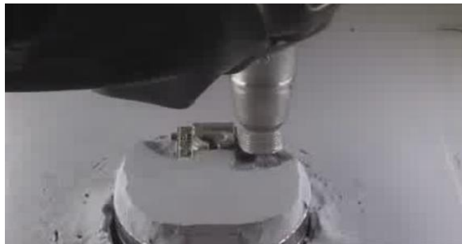
Figure 11 : Aspiration de la poudre non fusionnée, source N. Muller
