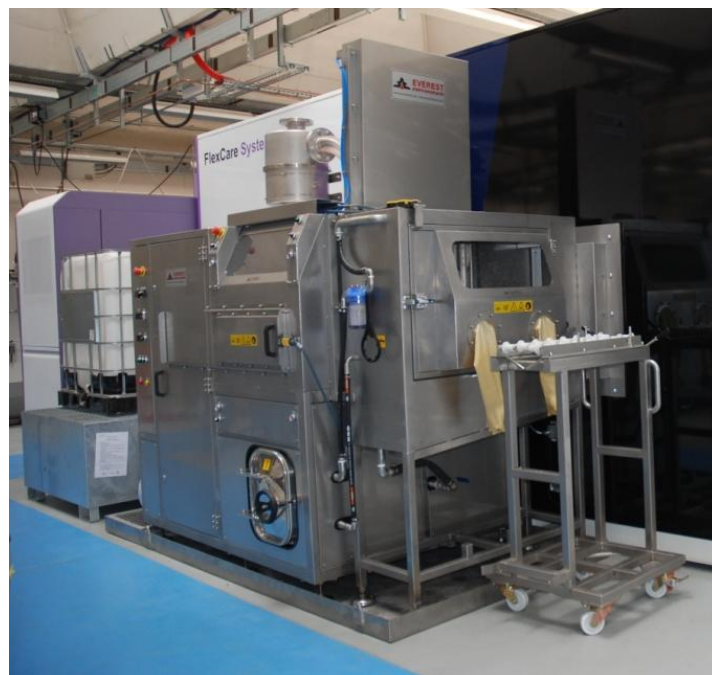
Figure 12 : Système de nettoyage et de stockage des eaux polluées
