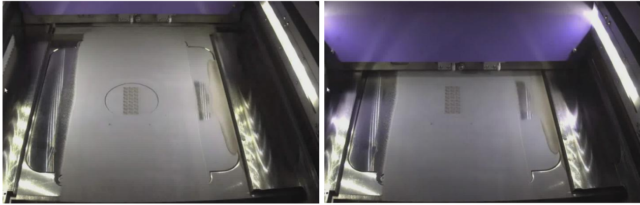
Figure 10 : Enceinte de la FormUp 350 en cours d'impression, source N. Muller
