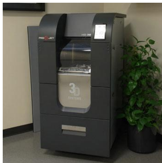
Figure 8 : Machine à projection de gouttes, Projet HD 3000 3D Systems, source [3]
