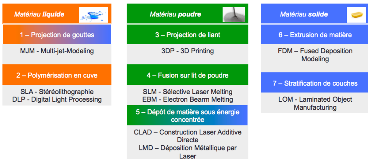
Figure 5 : Les sept familles de procédés de fabrication additive (Norme OSI 17296-2), source [2]
