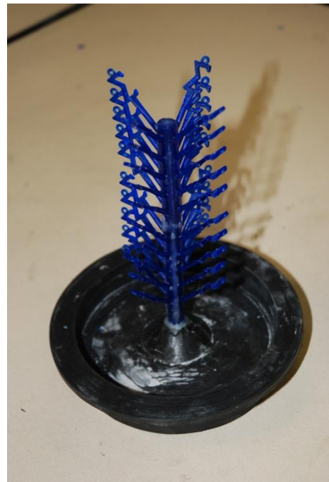
Figure 10 : Exemple de réalisation de pièces par polymérisation laser, source ressource « Moulage à cire perdue : du modèle à la pièce » [5]
