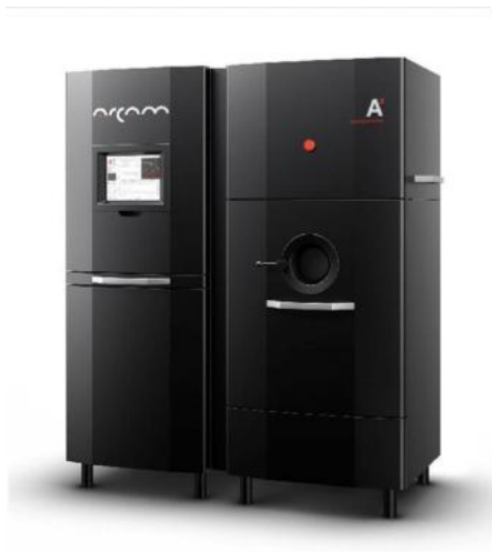
Figure 17 : Machine à solidification de poudre sous l'action de, source [3]
