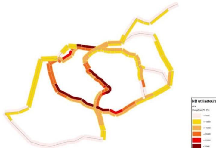
Figure 19 : Fréquentation du réseau selon la ligne à l'heure de pointe du matin, source [47]
