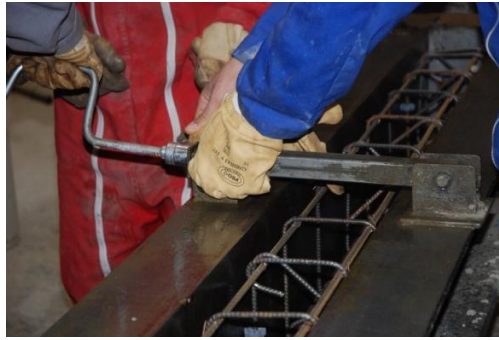
Figure 28 : Fermeture du moule
