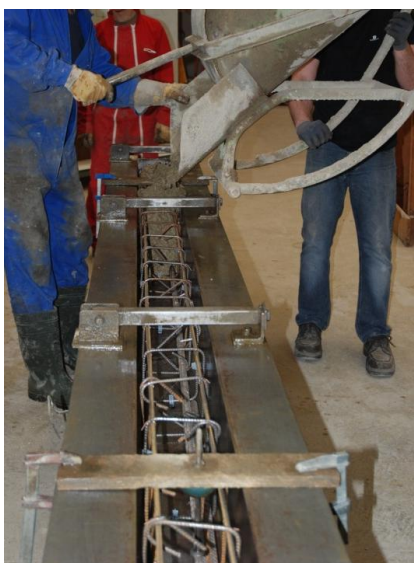
Figure 30 : Dépôt d'une première couche de béton
