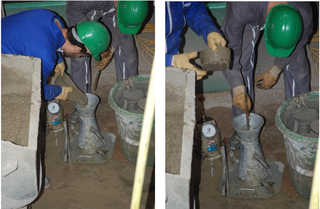
Figure 19 : Remplissage en 3 fois du cône d'Abrams, et piquage entre chaque couche
