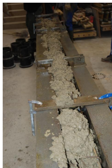
Figure 30 : Dépôt d'une première couche de béton
