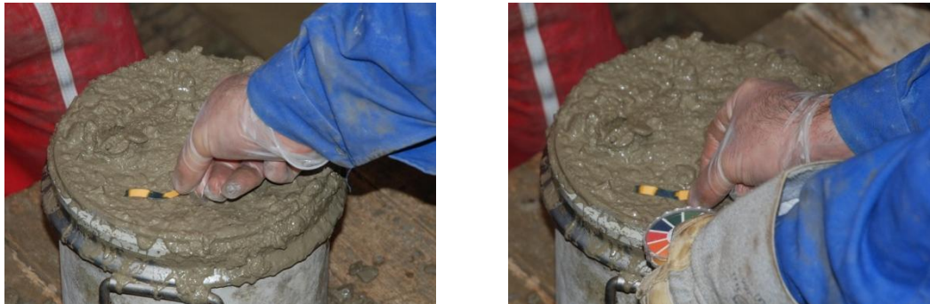
Figure 26 : Estimation du pH du béton
