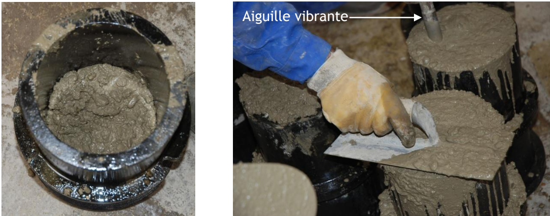
Figure 34 : Réalisation des six éprouvettes
