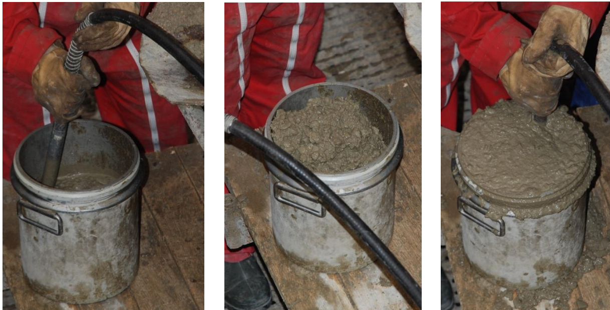
Figure 24 : Remplissage de la cuve de l'aéromètre en 2 fois avec du béton serré à refus
