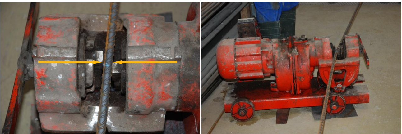
Figure 5 : Coupe des armatures par cisaillement
