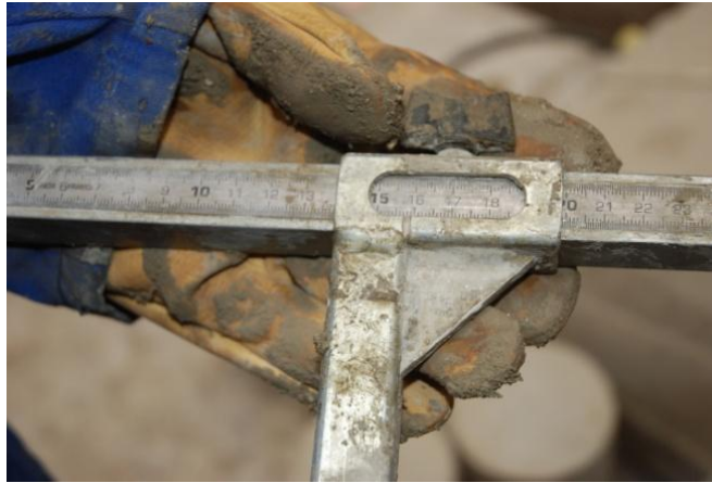
Figure 21 : Mesure de l'affaissement du béton frais
