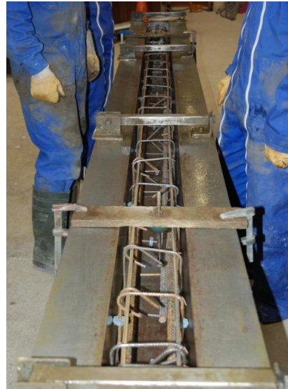
Figure 29 : Finalisation du moule avant remplissage de béton
