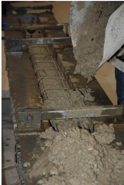
Figure 32 : Dépôt de la seconde couche et poutre vibrée
