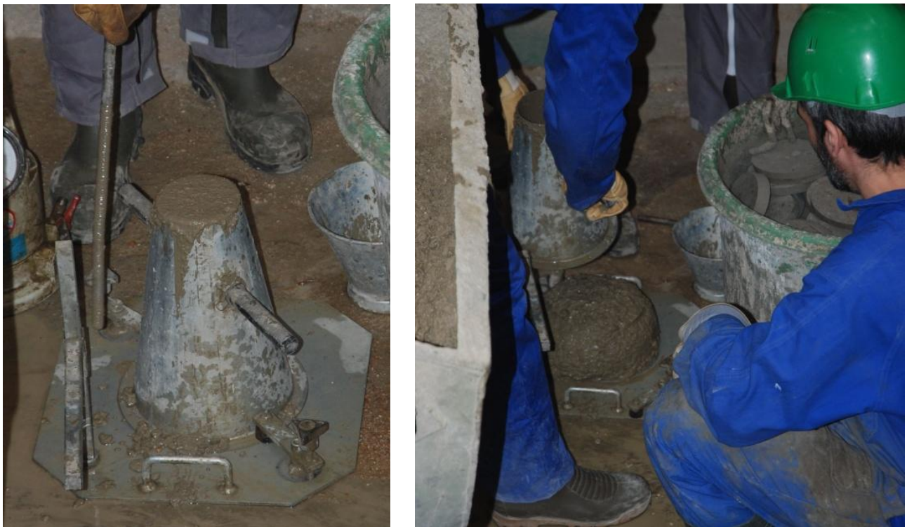
Figure 20 : Cône d'Abrams arasé puis soulevé, affaissement du béton frais
