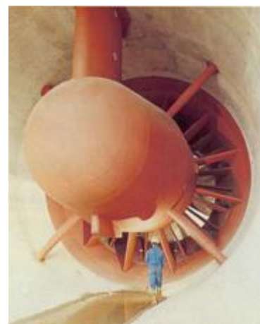
Figure 34 : Usine marémotrice de la Rance, source Conseil régional de Bretagne, et l'un des 24 groupes bulbes de 10 MW, source EDF
