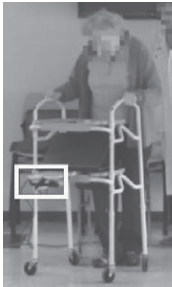
Figure 10 – Localisation de la caméra sur le déambulateur Walk-E
