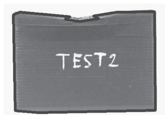
6-colis déformé avec ligne polygonale
