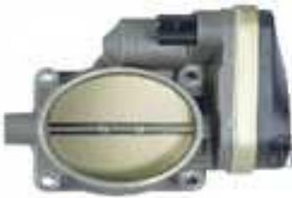
La commande électronique d'accélérateur (ETC) permet de gérer l'alimentation et la puissance donnée par le boîtier de commande électronique (ERC) au moteur.
