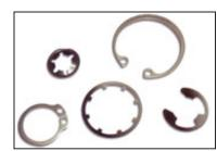
Les anneaux élastiques sont des composants d'assemblage mécanique généralement montés dans des gorges réalisées sur des portées cylindriques extérieures (arbres, axes, ...) ou dans des alésages. Ils permettent de réaliser des arrêts axiaux, des rattrapages de jeu destinés à réduire le bruit de fonctionnement des mécanismes, etc. Les applications sont très nombreuses en mécanique générale et dans de très nombreux secteurs industriels : automobile, électroménager, machines de bureau, etc...
