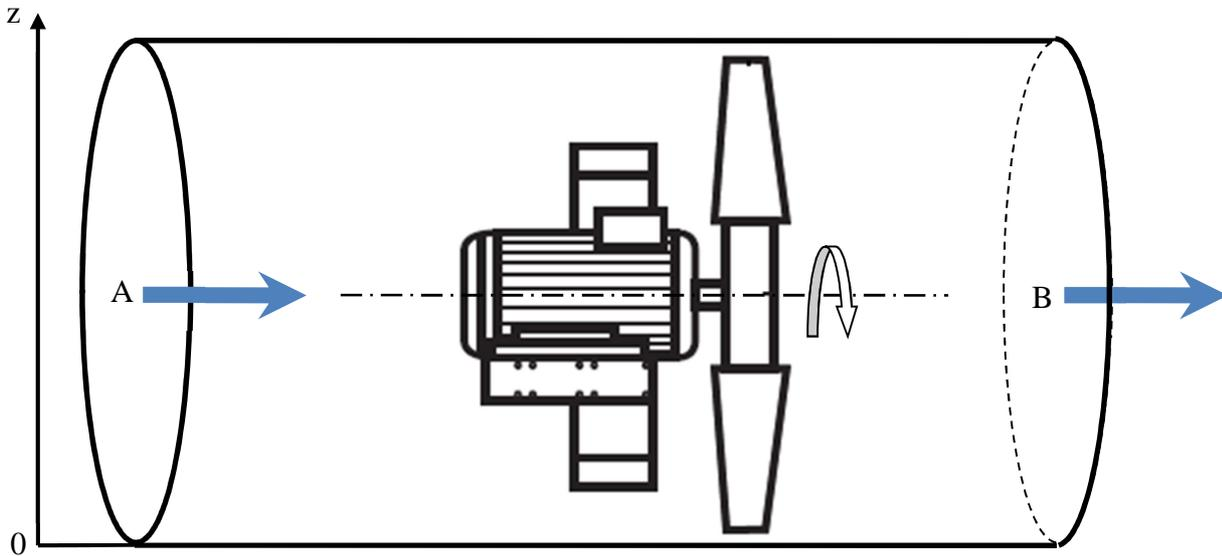
Figure 2 : motoventilateur placé dans sa virole
