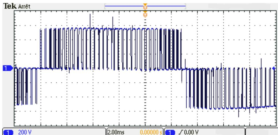
Figure 4 : oscillogramme de la tension  $u_{12}(t)$  (220V/div, 2ms/div)
