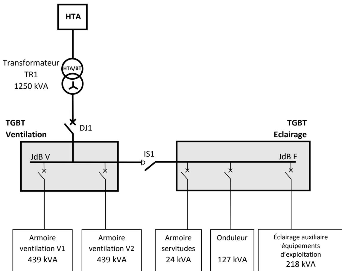
Figure 6 : schéma unifilaire de l'alimentation du tunnel
