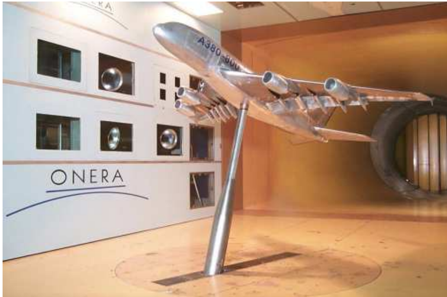
Illustration 1: Maquette de l'airbus A380 dans la chambre d'essai
