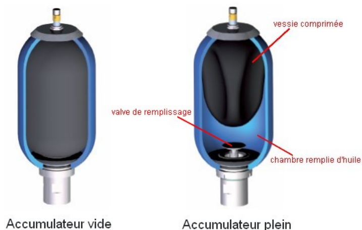
Figure 10 : états de fonctionnement d'un accumulateur hydraulique
