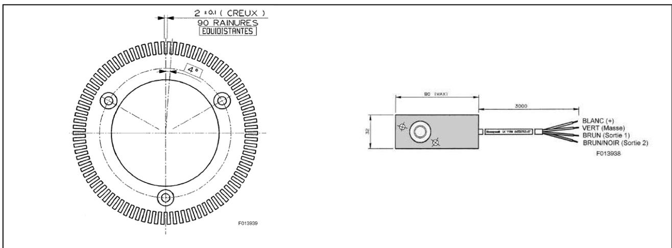
Fig. 1 : capteur de vitesse de rotation
