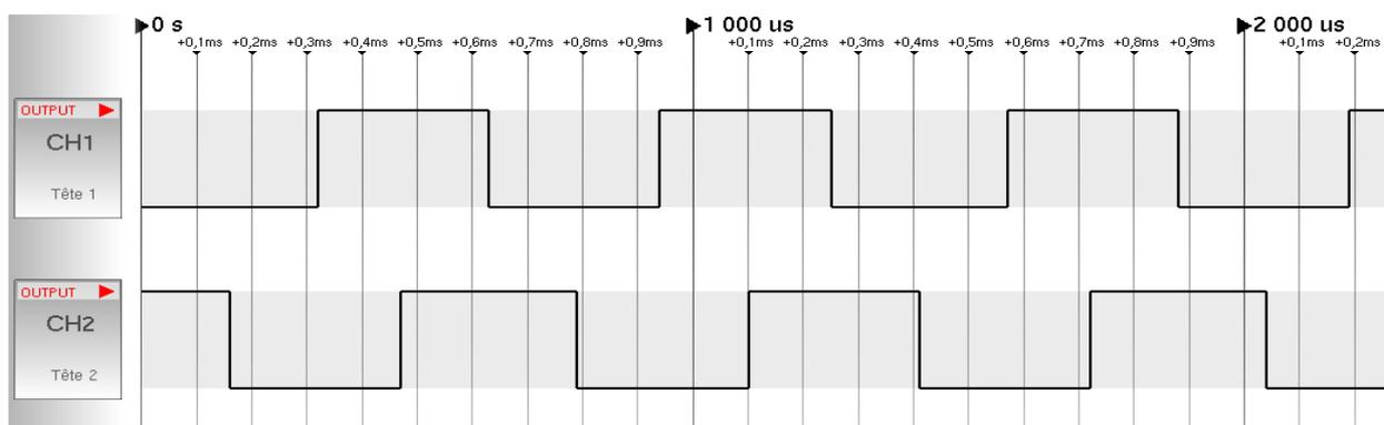
Figure 3 : Chronogramme des signaux relevés au niveau des têtes 1 et 2 du capteur de vitesse
