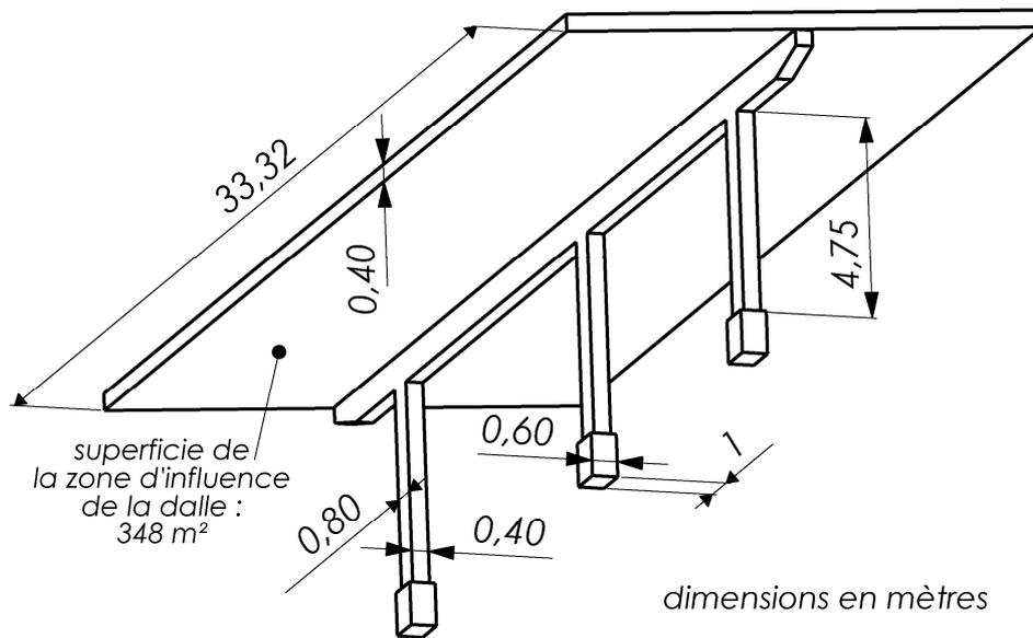
Figure 8 : zone d'influence de la dalle sur un ensemble poteaux-poutre
