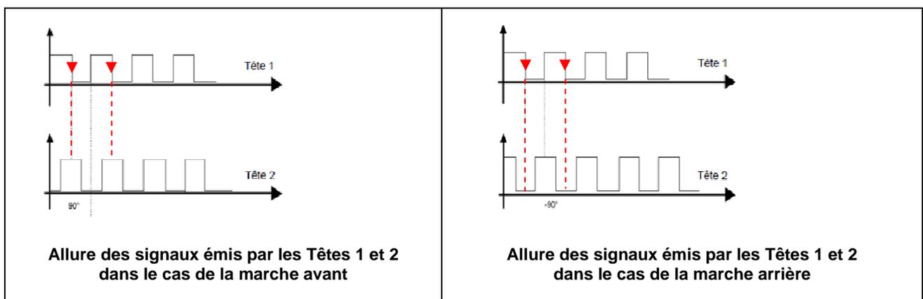
Fig. 2 : Détermination du sens de rotation en fonction des signaux du capteur
