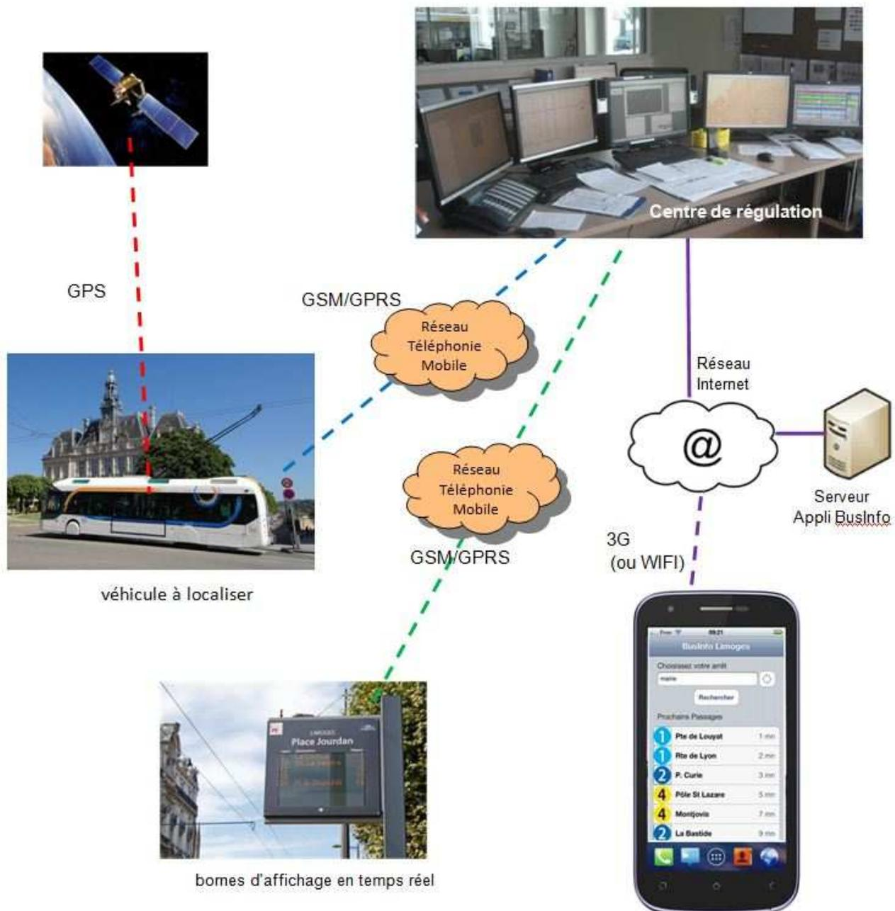
Figure 4 : géolocalisation et suivi en temps réel de la flotte de véhicules, et information aux voyageurs (bornes d'affichage, application smartphone)
