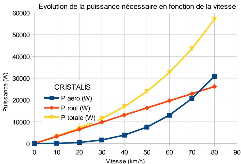
Figure 2 : puissance utile sur le plat à vitesse constante
