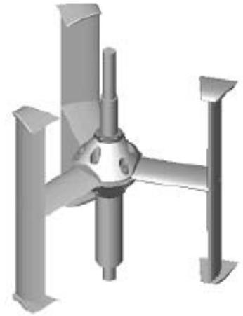
Figure 5 : turbine Achard NACA 0018
