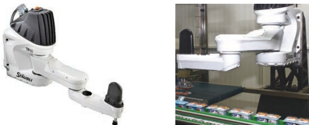
Figure 3 : robot 4 axes dit « à plans parallèles » et exemple d'implantation
