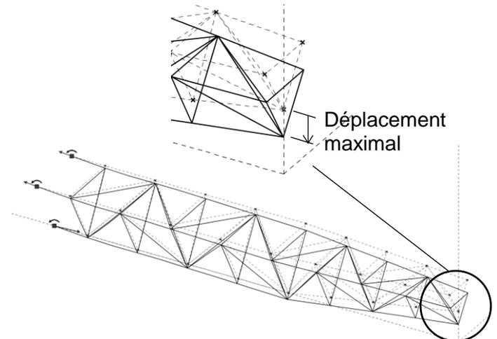
**Simulation mécanique du déplacement maximal de l'empennage du treillis.**
