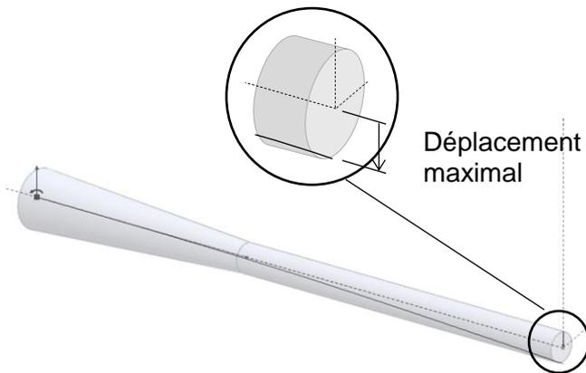
**Simulation mécanique du déplacement maximal de l'empennage du tube.**
