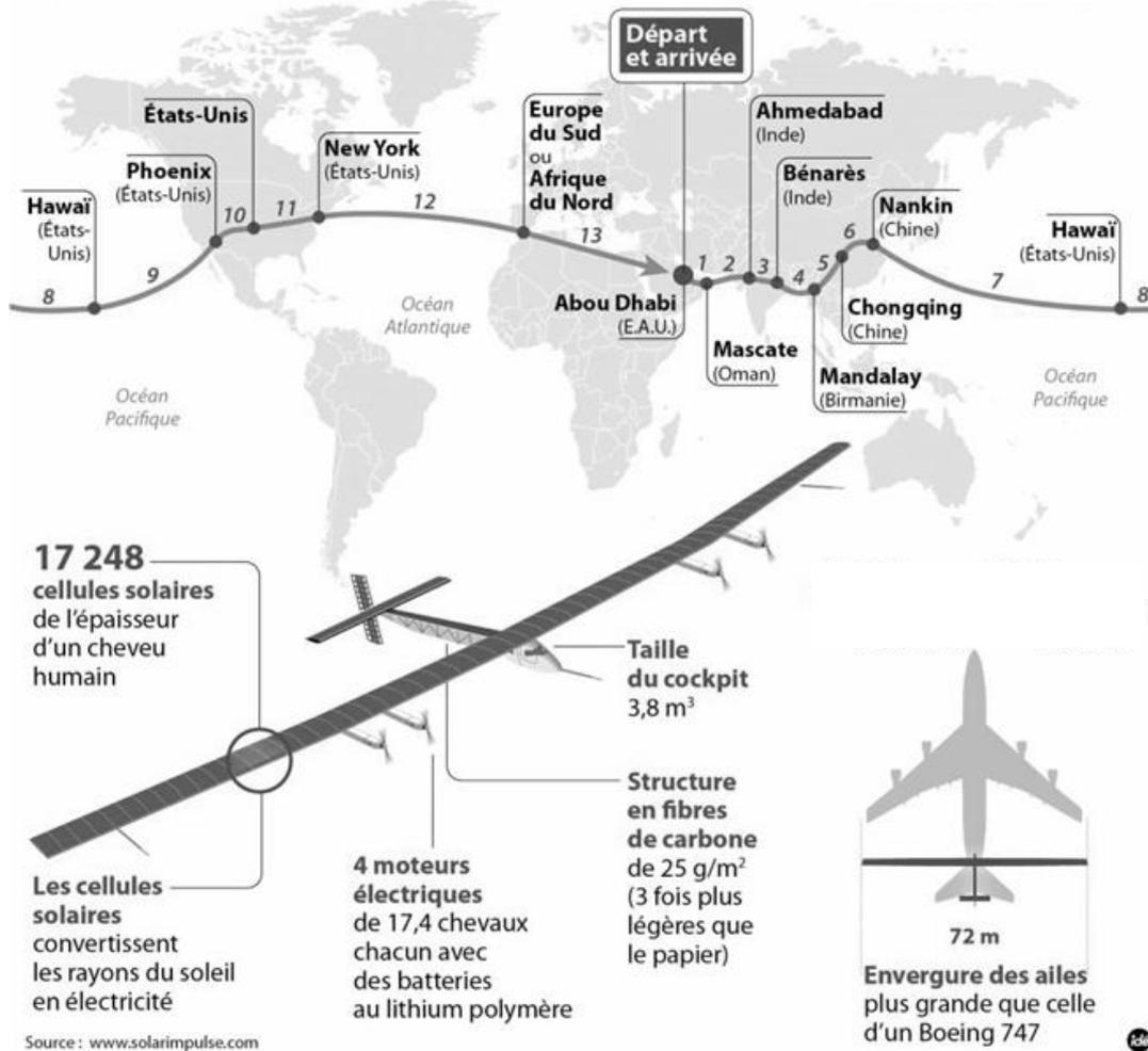
Le Solar Impulse 2 est basé sur des technologies récentes, comme les cellules photovoltaïques, les batteries au lithium-polymère et les matériaux ultralégers en fibre de carbone. Pour que le projet aboutisse, chaque élément de l'avion a été conçu et optimisé pour réduire la masse de l'avion, augmenter son aérodynamisme, réduire sa consommation d'énergie et maximiser le rendement des cellules photovoltaïques.
