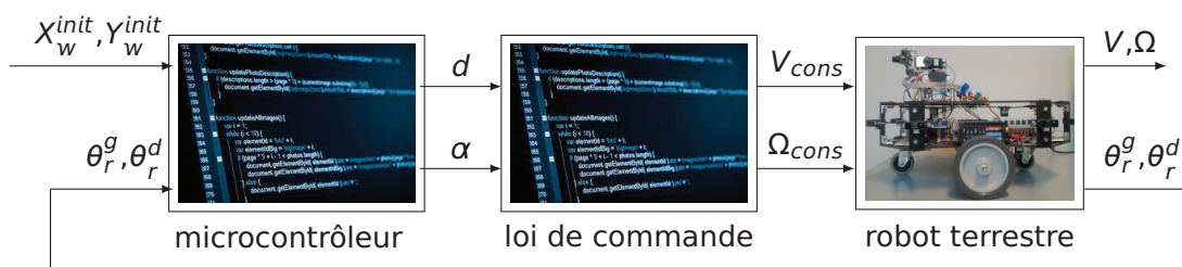
Figure 25 – Description structurelle du modèle acausal du robot collaboratif.
