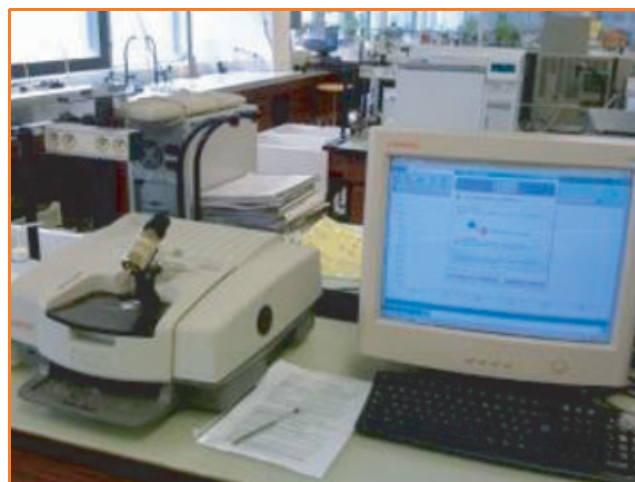
Figure 3 - Le spectromètre infrarouge utilisé durant la séance de TP (Avatar 320 FT-IR, Thermo Nicolet).
